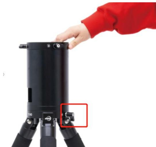
正向装入多功能支撑杆（如下图 1 所示），顺时针旋转多功能支撑杆上的旋钮锁紧，装上三角支撑盘，顺时针旋转旋钮锁紧。
